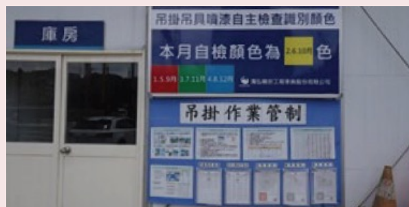
吊掛吊具噴漆自主辨識
