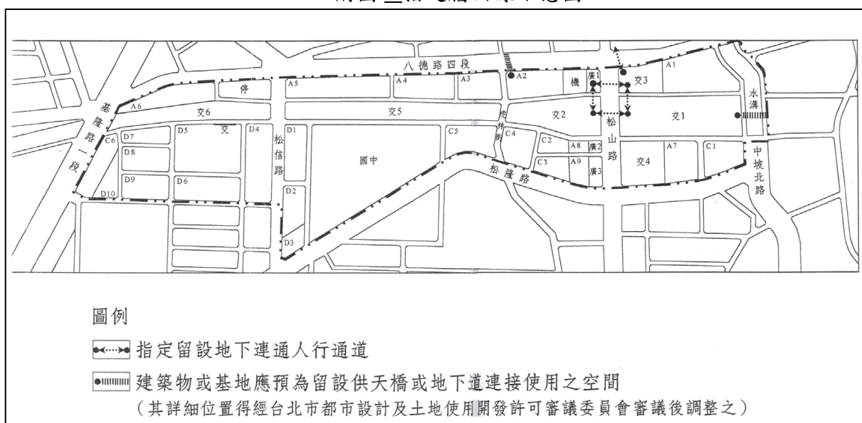
附圖 4 指定留設地下連通人行通道及立體人行系統示意圖
