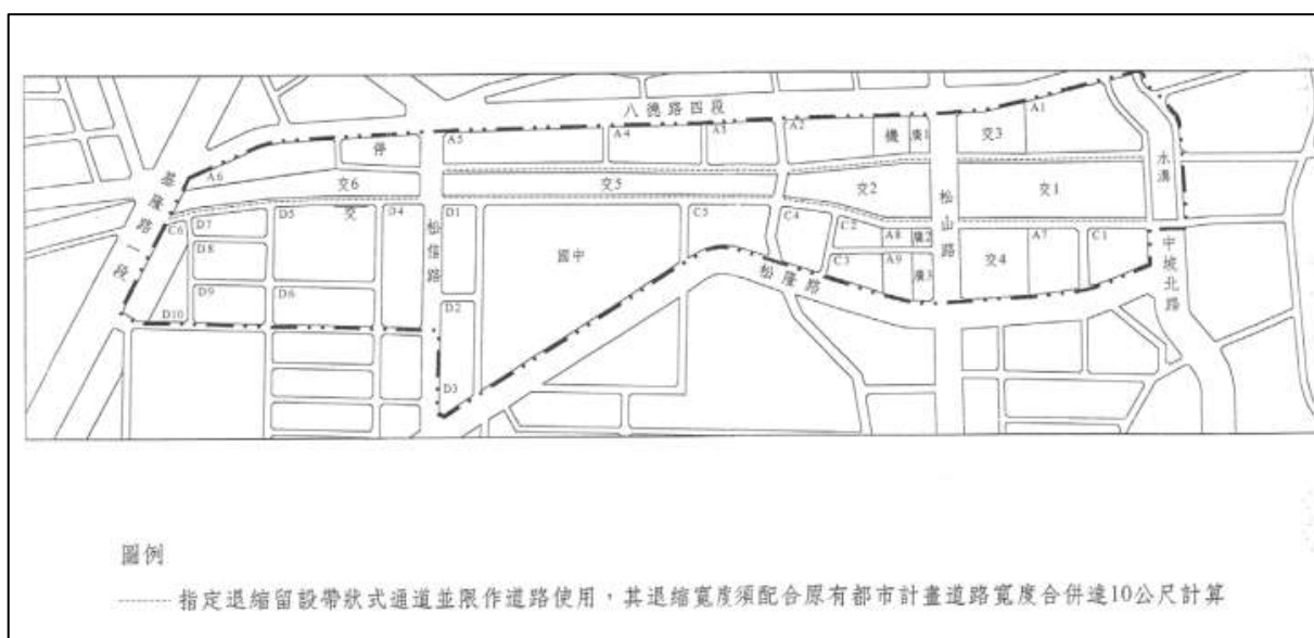
附圖 2 交通用地退縮帶狀式通道並限作道路使用示意圖
